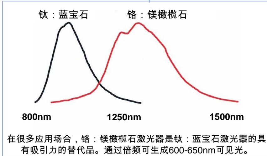
完整的放大太瓦铬：镁橄榄石系统可在1250nm提供1-2太瓦的峰值输出功率。典型脉冲长度为60飞秒。单脉冲能量超过120mJ。
