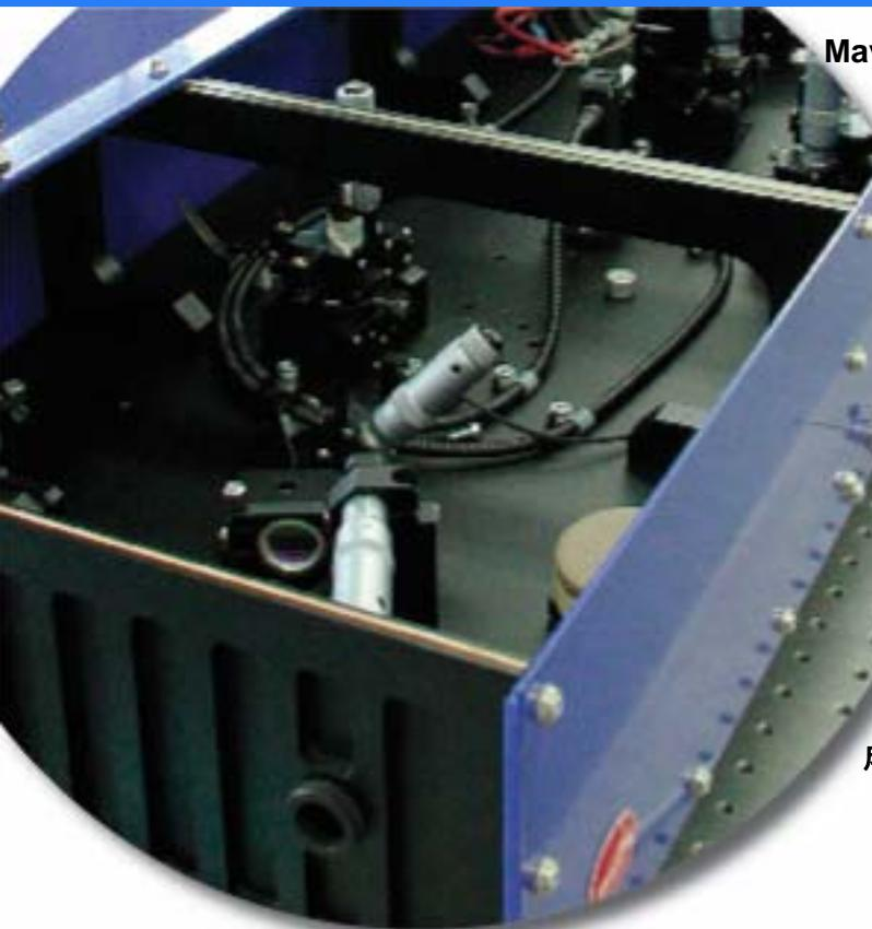
Mavericks-65铬：镁橄榄石激光器1230 - 1270nm的波长调节范围使其成为成像，聚合物及生物医学等领域的理想工具。与钛：蓝宝石及其他飞秒激光器所生成的短波长相比，这些波长对生物样品的损害相对较小。这有利于对细胞和其他生物样品的活体成像。有些组织样品对短波长不透明，使用1200nm以上波长，则使对这些样品的成像成为可能。对光学相干断层扫描术(OCT)等成像技术来说，铬：镁橄榄石激光器是其他超快激光介质有吸引力的替代品。利用铬：镁橄榄石光源的相干特性，光学相干断层扫描术可对生物样品在微米尺度的形态结构和功能，例如细胞发育，进行高分辨率研究。由于轴向分辨率主要由光源带宽决定，高带宽铬：镁橄榄石激光器可以提供非常好的成像分辨率和景深。
