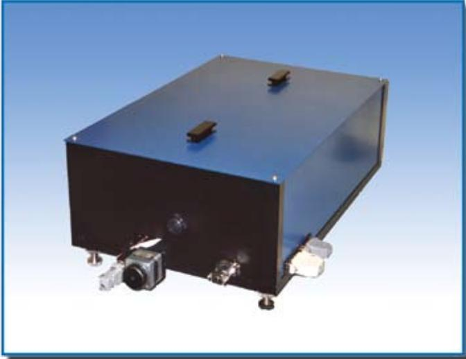
您的飞秒激光器输出有多好？新的三阶互相关器是为大批量测量包括激光脉冲对比度，脉冲基座，前、后脉冲，以及放大自发辐射在内的超快激光系统输出参数而专门开发的。它也可以在飞秒量级提供关于脉冲强度的第三阶互相关函数，并可被用于高功率飞秒激光器的调试和校准。输入脉冲的一部分经一非线性晶体被转换为二阶谐波（SH）。分色镜反射二阶谐波而透射基波，将光束分为两路导入互相关器。基波光路包含一个回射器和延迟。基波经过延迟后与二阶谐波汇合并聚焦在DKDP或BBO（取决于输入脉冲波长）晶体内。基波和二阶谐波脉冲在非线性晶体内的混频导致非共线三阶谐波（TH）的生成。通过过滤掉基波和二阶谐波频率成分，三阶谐
